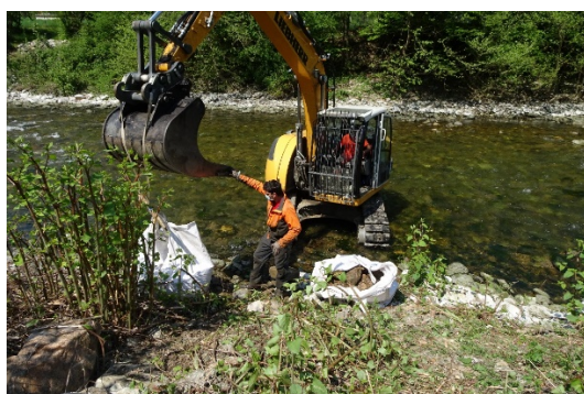
Figura 23 Prelievo di campioni dal fiume Tresa nella zona in cui sono previste le rampe in blocchi
