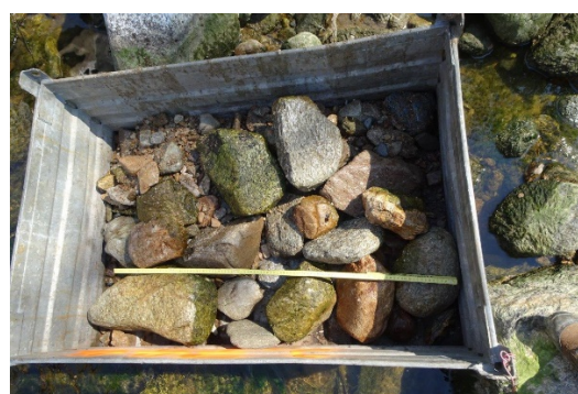
Figura 23 Prelievo di campioni dal fiume Tresa nella zona in cui sono previste le rampe in blocchi
